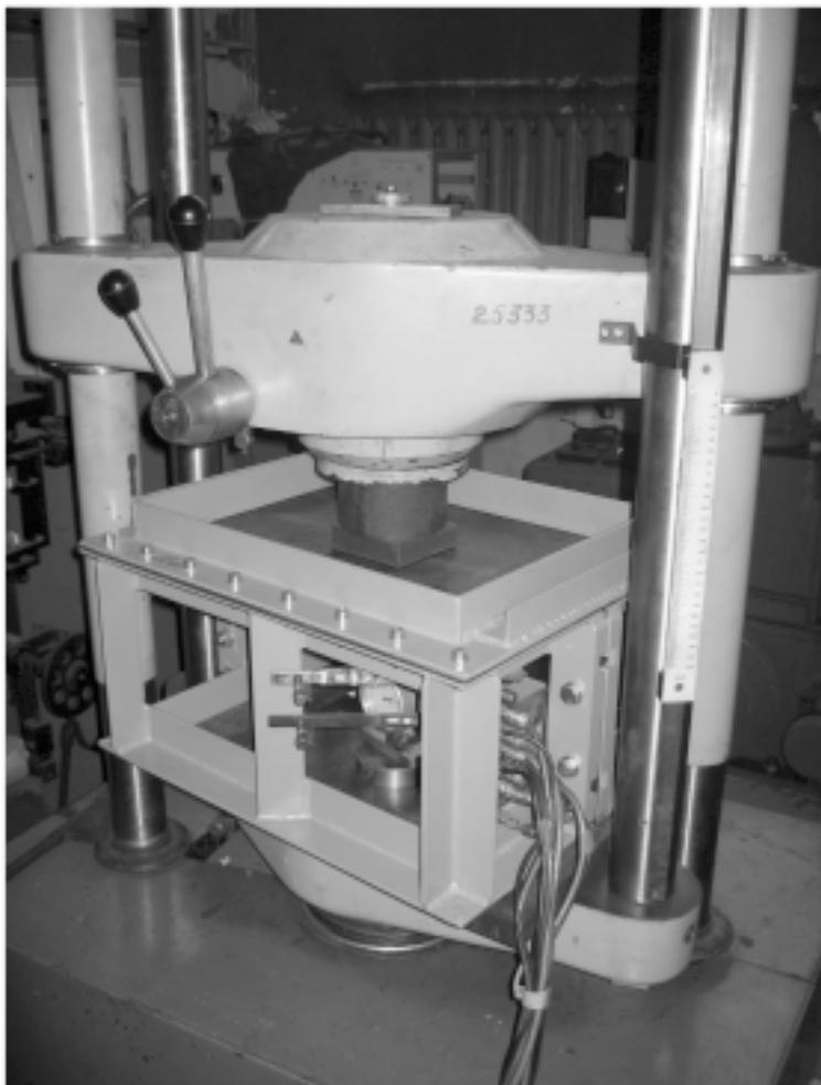
Рис. 4. Общий вид модели в жесткой коробчатой раме, установленной на испытательной машине
