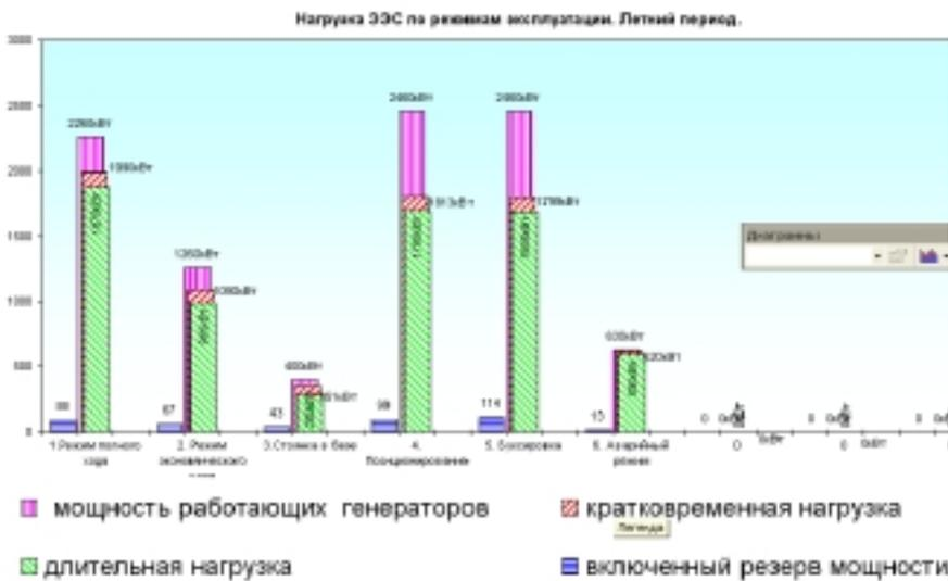
Рис. 3. Нагрузка ЭЭС по режимам эксплуатации
