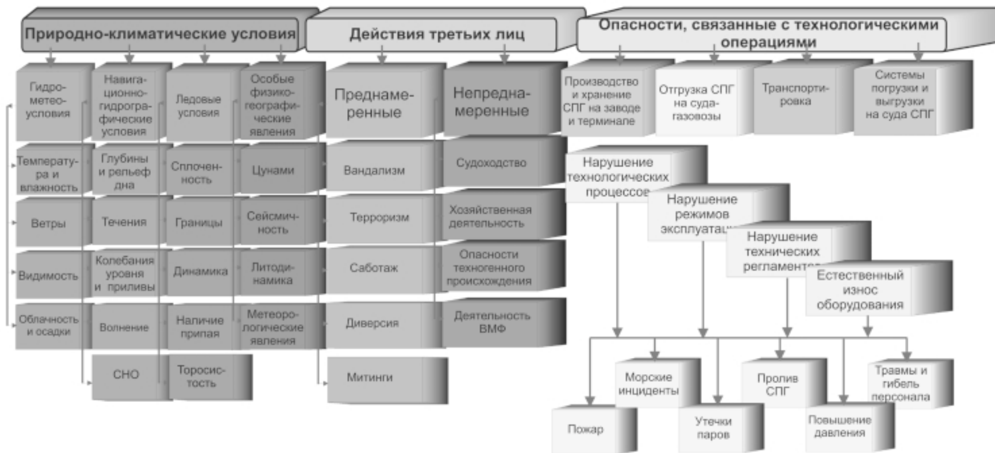
Рис.2. Классификация опасных факторов для системы морской транспортировки сжиженного газа
