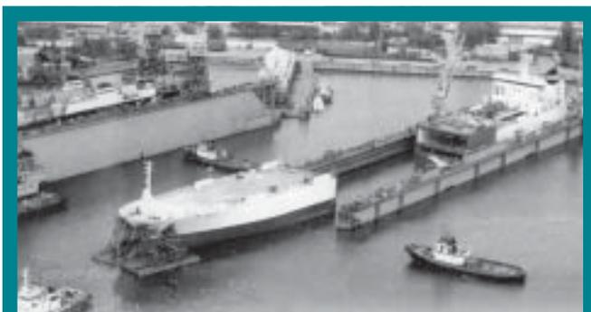
Рис.13. Использование плавучего дока для удлинения корпуса судна
