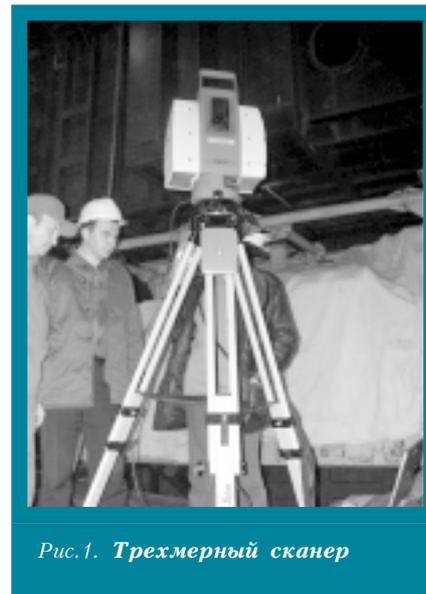
Рис.1. Трехмерный сканер
