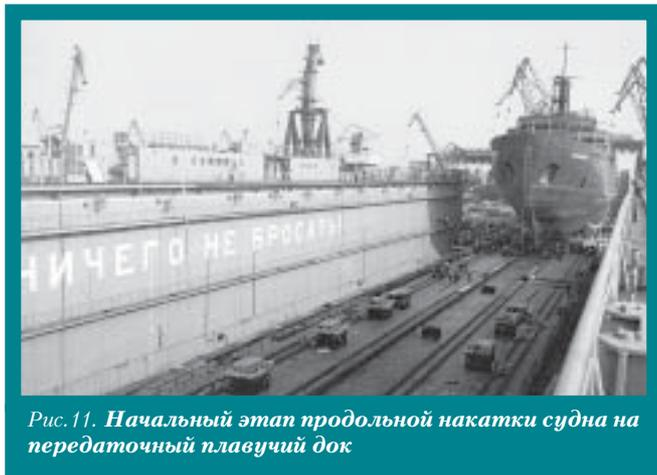
Рис.11. Начальный этап продольной накатки судна на передаточный плавучий док
