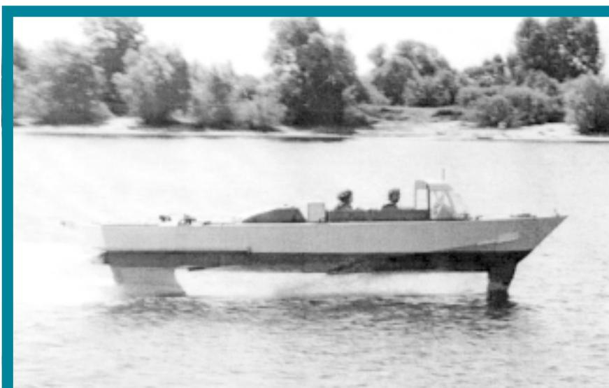
Рис. 15. Модель СПК второго поколения на испытаниях
