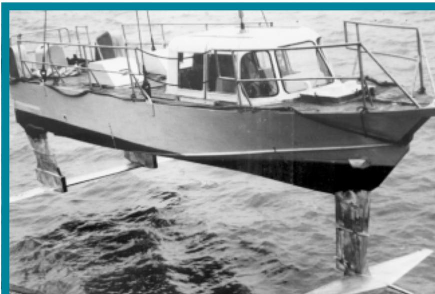
Рис. 14. Компоновочная схема СПК второго поколения (самоходная модель)
