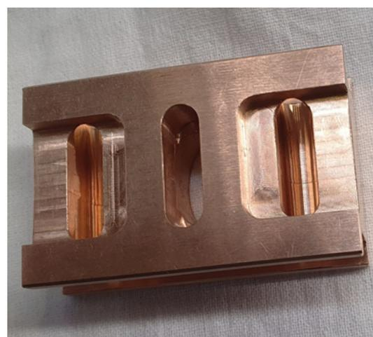
Рис. 4. Поверхность золотника из бронзового сплава БрОФ7-0,2 до начала ресурсных испытаний
