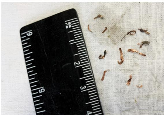
Рис. 7. Следы износа плоской золотниковой пары (золотника из бронзового сплава) обнаруженные в картере масляной станции после проведения ресурсных испытаний
