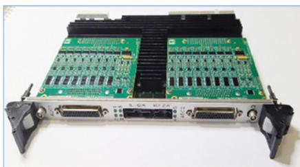
Рис. 4. Корабельный вариант МВСГАС: а – блок обработки сигналов высокопроизводительного модема; б – процессорный модуль О42С с шиной CompactPCI; в – модуль предварительного усиления; г – модуль процессора ЦОС ADP201cP5 с шиной CompactPCI
