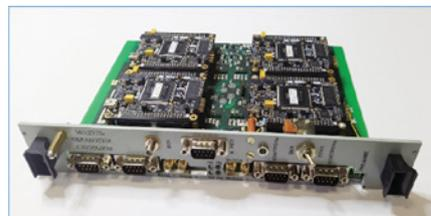
Рис. 5. Вариант МВСГАС с низким энергопотреблением: а – крейт OSC-S724A9-03D с шиной CompactPCI и блоком питания AC/DC; б – модуль предварительного усиления; в – модуль обработки сигналов модема МВСГАС с низким энергопотреблением
