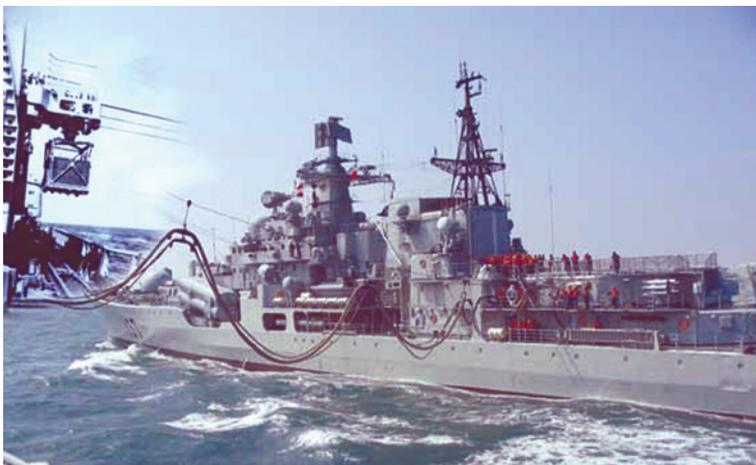
Рис. 1. Устройство передачи сухих и жидких грузов в море на ходу траверзным способом
