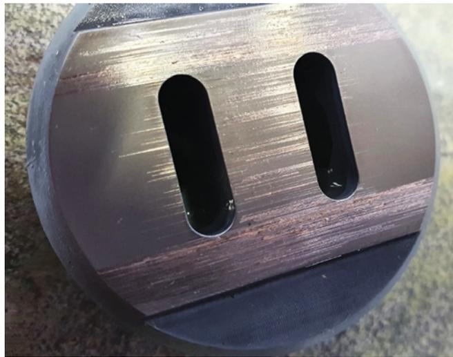
Рис. 5. Поверхность трения зеркала из титанового сплава ЗМ (покрытая оксидированным слоем в графите) после проведения ресурсных испытаний
