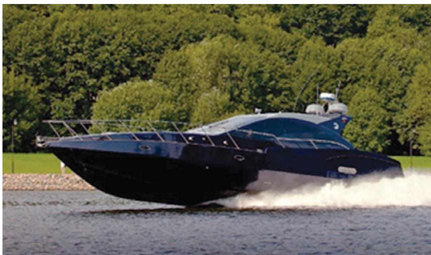
Рис. 4. Скоростная моторная яхта «Стриж»
