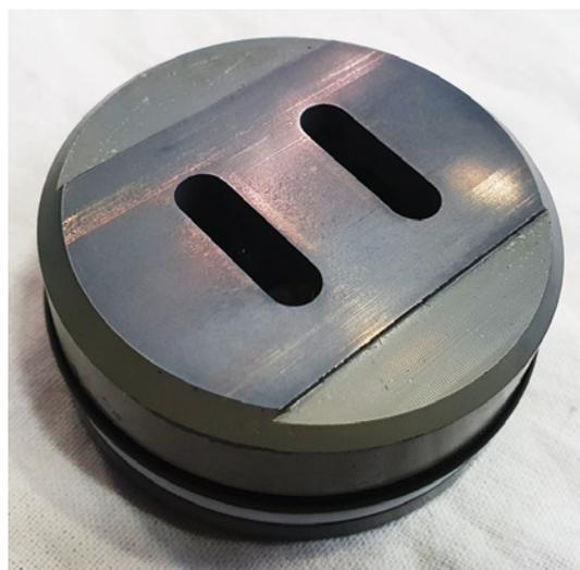
Рис. 3. Поверхность трения зеркала из титанового сплава 3М (покрытая оксидированным слоем в графите) до начала проведения ресурсных испытаний. На поверхности оксидного слоя наблюдается следы приработки бронзового сплава
