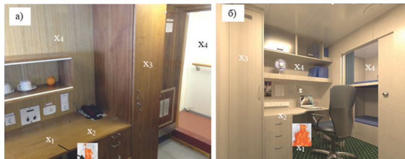
Рис. 3. Общий вид оборудования и мебели в каютах на корабле: а – деревянная мебель; б – металлическая мебель
