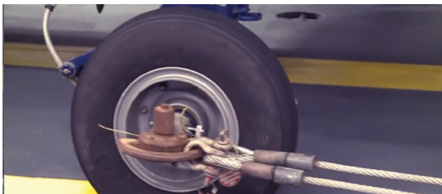
Рис. 8. Крепление тросов к шасси вертолета «Лунх»
