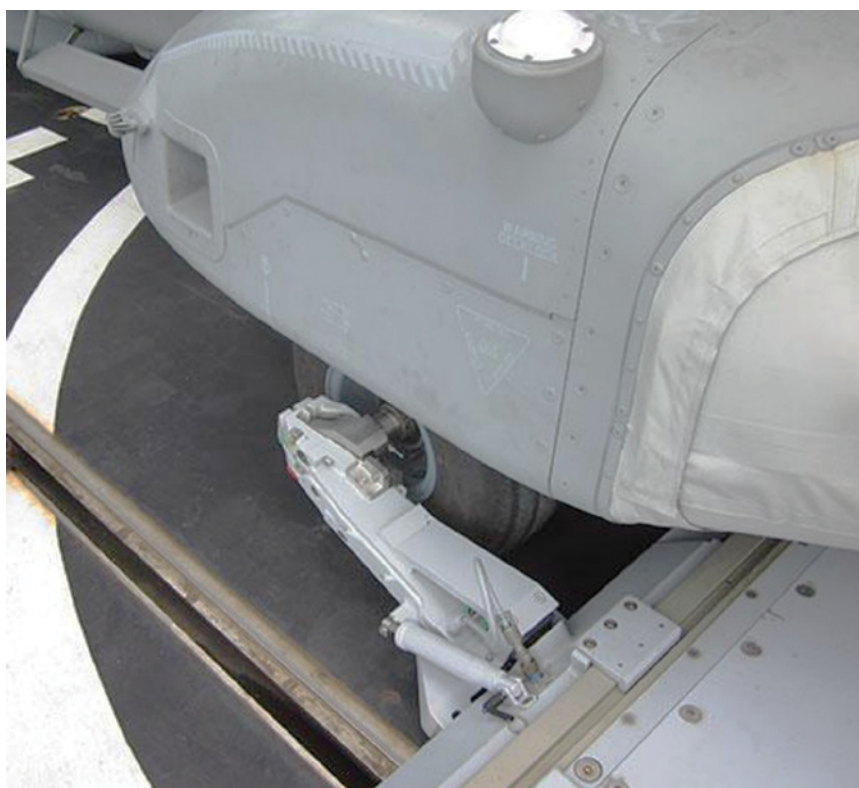
Рис. 17. «Клешня» тележки RSD в захвате с выступающей осью колеса вертолета основной стойки шасси
