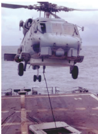
Рис. 3. Приземление вертолета на палубу системой RAST
