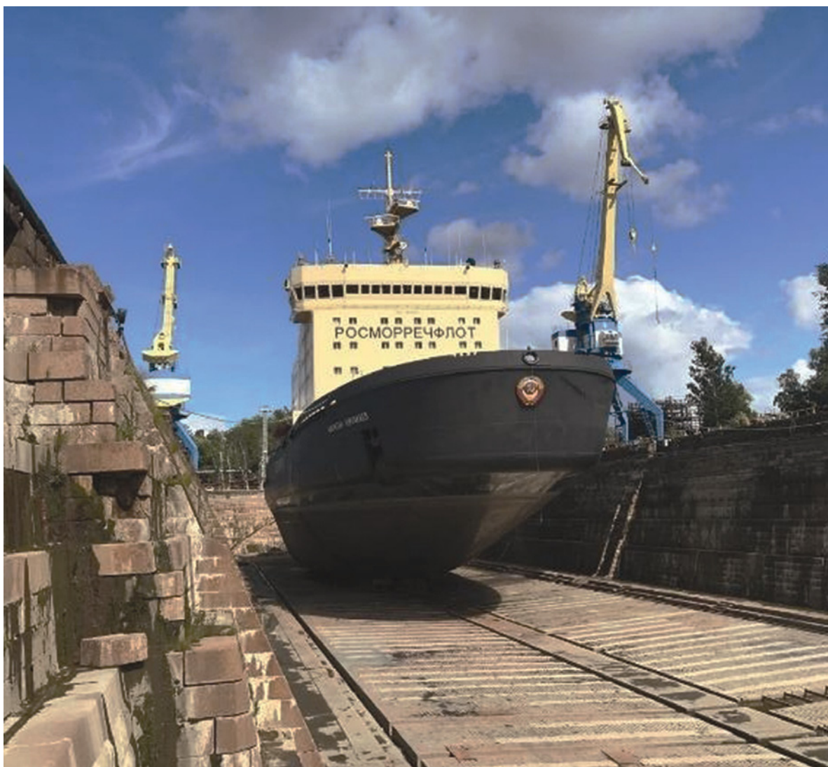
Рис. 1. Доковый ремонт судна в сухом доке
