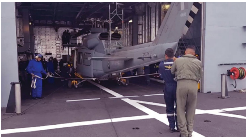
Рис. 13. Транспортування вертольота з ангару системою компанії BADA URL: https://www.youtube.com/watch?v=ZCCMzdoZSCg&t=263s (дата звернення 15.06.2021).
