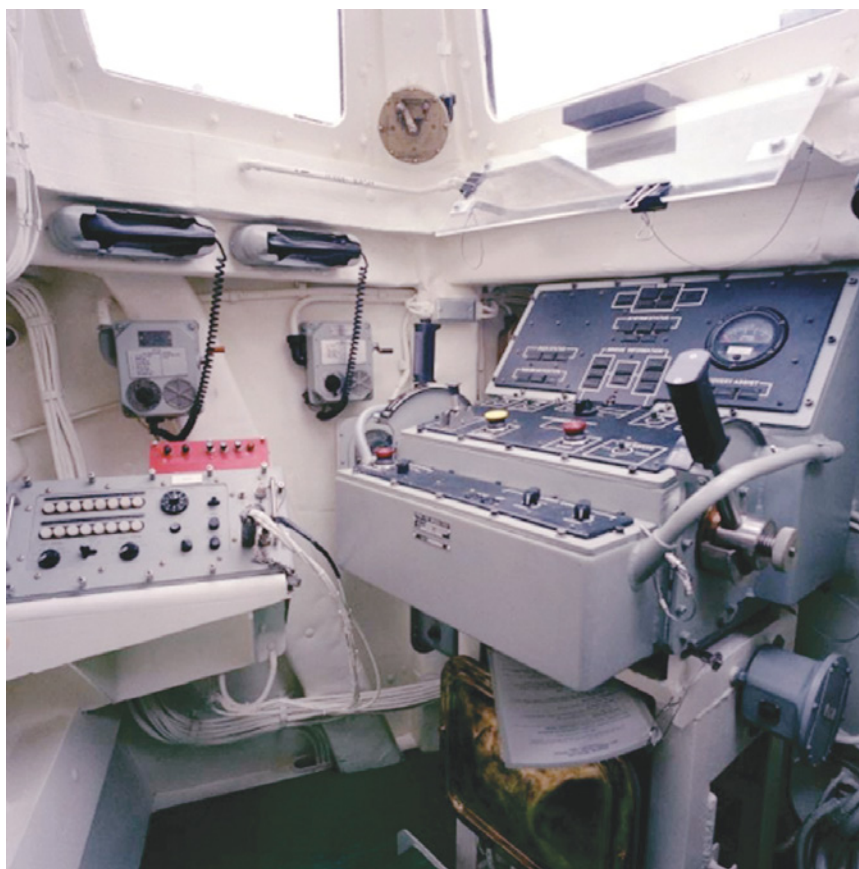
Рис. 6. Пульт управления системой RAST
