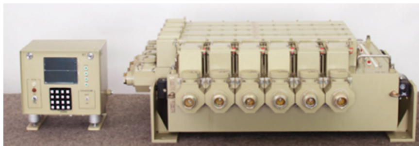
Рис. 5. Коммутатор передающих антенн Ю-627
