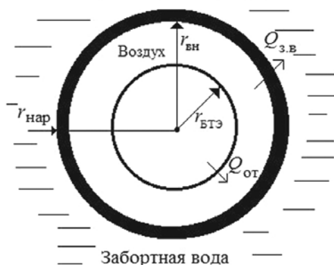
Рис. 3. Схематический разрез отсека АНПА БД с БТЭ
