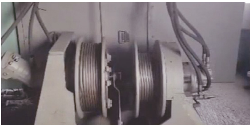
Рис. 14. Одна з двох кормових гідравлічних лебідок на єдиній рамі з ограничителем системи компанії BADA URL: https://www.youtube.com/watch?v=ZCCMzdoZSCg&t=263s (дата звернення 15.06.2021).
