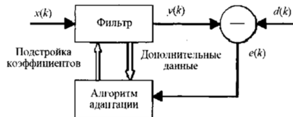
Рис. 1. Общая структура адаптивного фильтра
