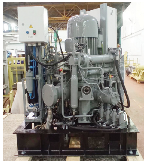
Рис. 1. Станция компрессорная автоматизированная СКА 60/200
