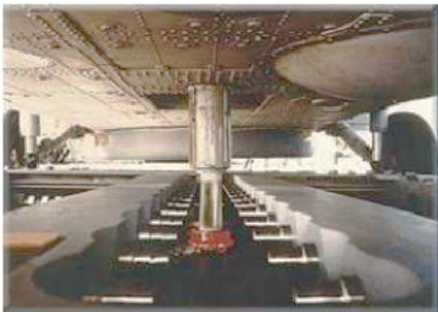
Рис. 4. Зонд вертолета перед захватом тележки RSD
