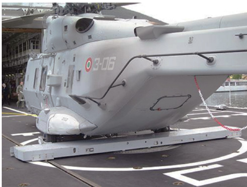
Рис. 16. Вертолет с закрепленным RSD системы TC-ASIST
