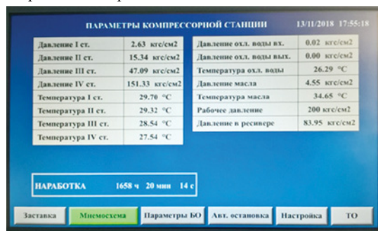
Рис. 3. Дисплей прибора управления ПУ СКА60/200
