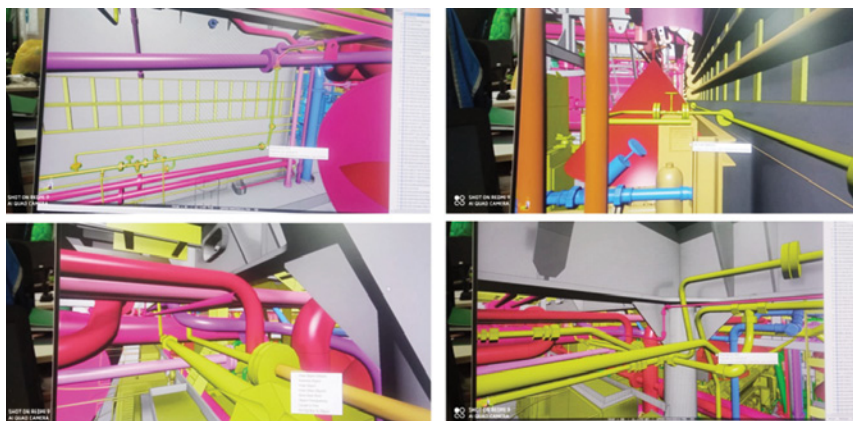
Рис. 3. Трехмерные модели судовых систем
