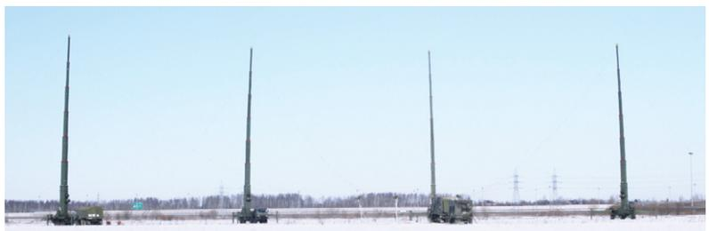
Рис. 10. Опытные образцы комплексов КВ диапазона различного назначения на базе 4-элементных АФАР
