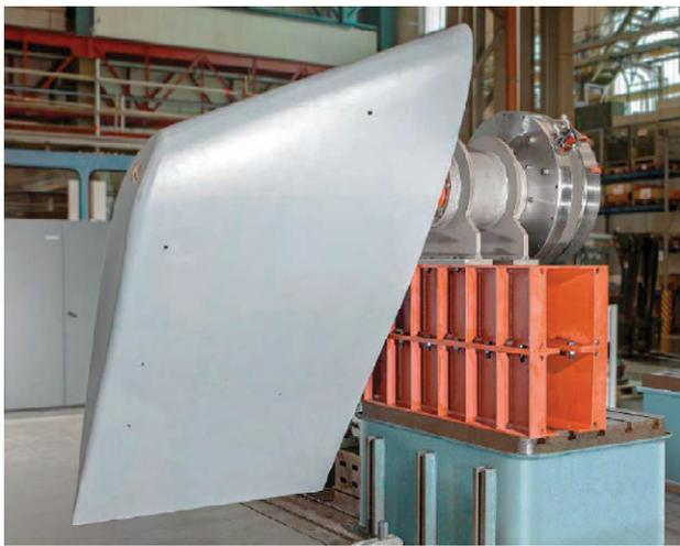
Рис. 6. Привод FZ на стенде завода-изготовителя
