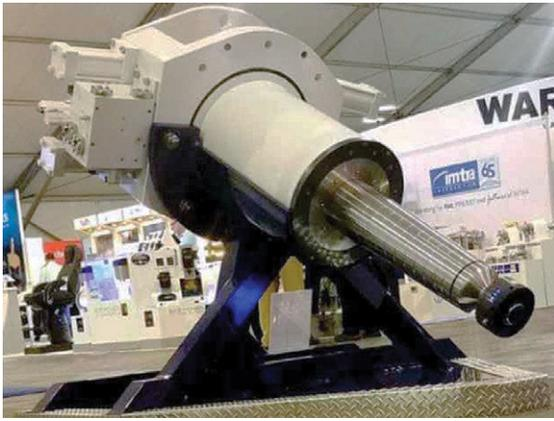
Рис. 10. Привод к баллеру УК Naiad model 820. Вид на баллер
