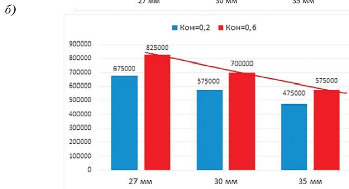
Рис. 2. Изменение затрат электроэнергии на компенсацию потоков тепла через теплоизоляционную конструкцию корпуса корабля с изменением толщины изоляции при базировании корабля в Баренцевом (а) и Черном (б) морях
