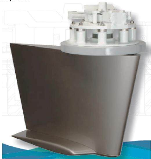
Рис. 8. Привод к баллеру УК TRAC
