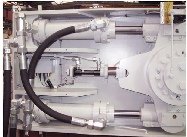
Рис. 13. Привод к баллеру УК BV type F
