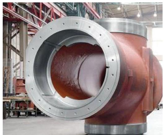
Рис. 3. Корпус подшипников баллера успокоителя качки фирмы Blohm+Voss
