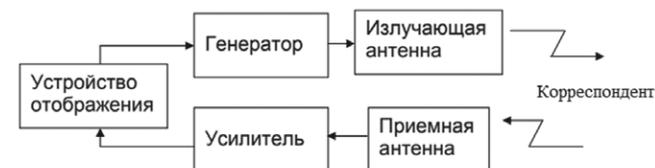
Рис. 1. Общая структурная схема активного гидролокатора
