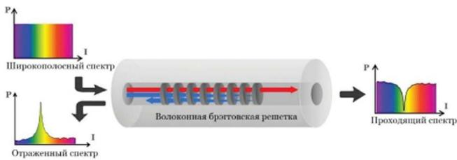
Рис. 2. Схема волоконно-оптической брэгговской решетки
