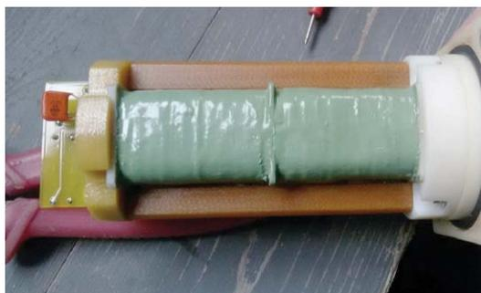
Рис. 4. Внешний вид чувствительного элемента датчика ДКП
