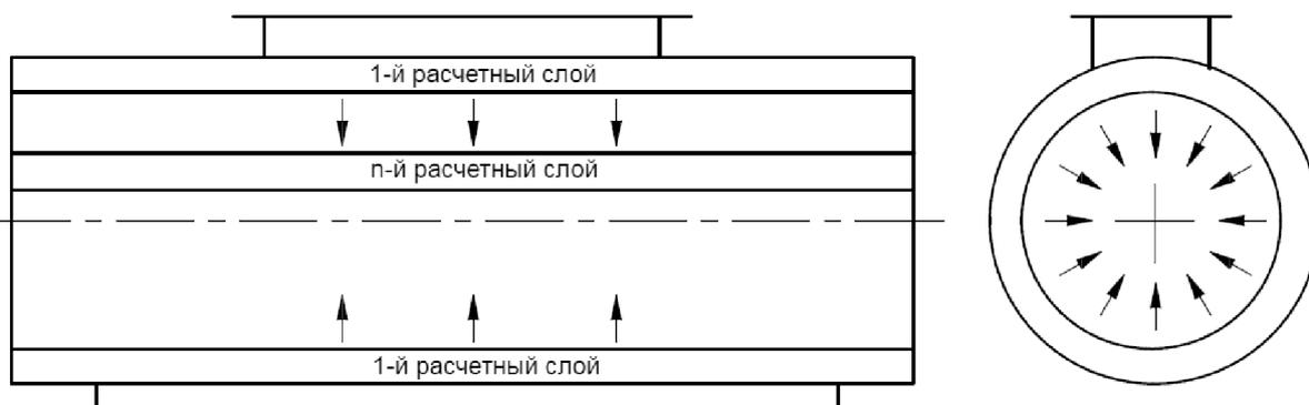
Рис. 1. Послойный тепловой расчет конденсатора
