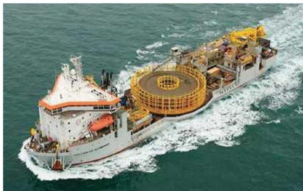
Рис. 8. Общий вид кабелеукладочного судна
