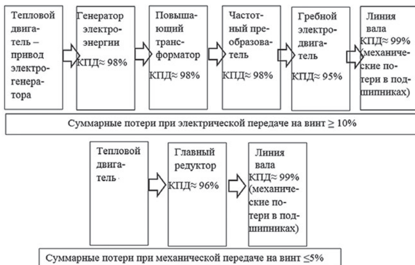
Рис. 16. Сравнительная характеристика потерь при электрической и механической передачах крутящего момента от теплового двигателя на винт
