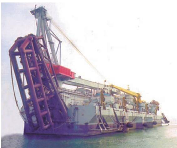
Рис. 8. Общий вид трубоукладчика «И. Гусейнов»: а – в рабочем положении при укладке трубопровода; б – в «походном» положении
