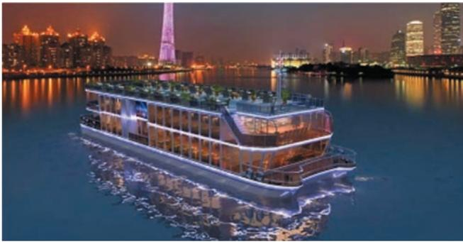
Рис. 12. Общий вид прогулочного судна, работающего на аккумуляторных батареях, на реке Жемчужная в Гуанчжоу. Источник: [23]
