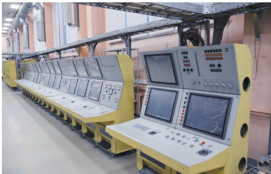
Рис. 1. Стойки единой интегрированной системы управления крейсером пр. 1144 с двубортной ЯЭУ
