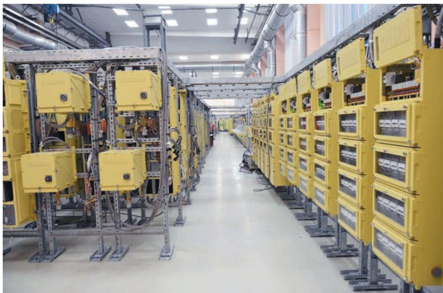
Рис. 2. Интегрированная система управления крейсером пр. 1144 с двубортной ЯЭУ на стенде концерна в период комплексной отладки
