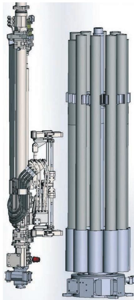
**Рис. 6. Манипулятор подачи труб с барабаном и механизмом разворота**
