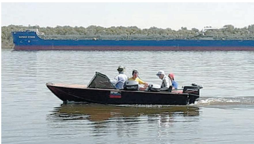
Рис. 1. Моторная лодка «Южанка-2» с подвесным лодочным мотором «Mercury 30» на испытаниях
