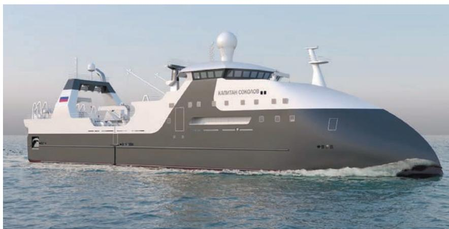
**Рис. 3. Морозильный траулер-процессор пр. 170701, строительство серии из десяти судов ведется на Северной верфи**
