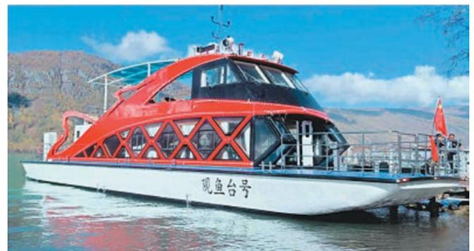
**Рис. 10. Общий вид прогулочного судна «Guanjutai», работающего на аккумуляторных батареях, на озере Канас, 2019 г. постройки. Источник: [23]**
