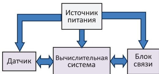
Рис. 1. Структурная схема подводного сенсора
