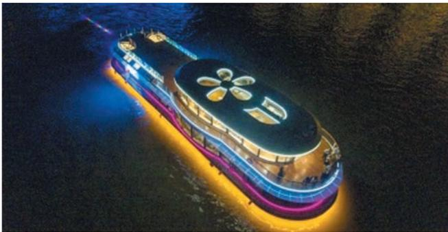
Рис. 13. Общий вид прогулочного судна в порту Сямьнь, работающего на аккумуляторных батареях. Источник: [23]
