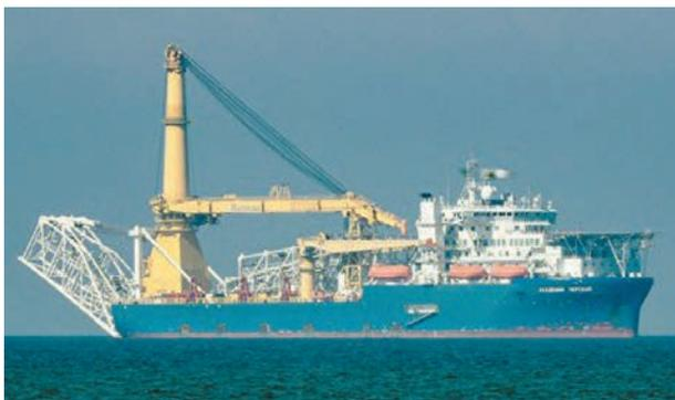
Рис. 1. Общий вид трубоукладочного судна «Академик Черский»
