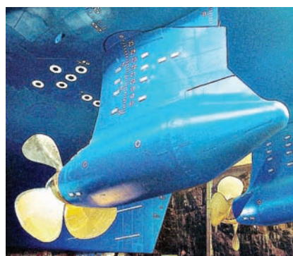
Рис. 3. ДРК фирмы ABB, тип Azipod VI, A_E/A_0 \approx 0,8-1,0
