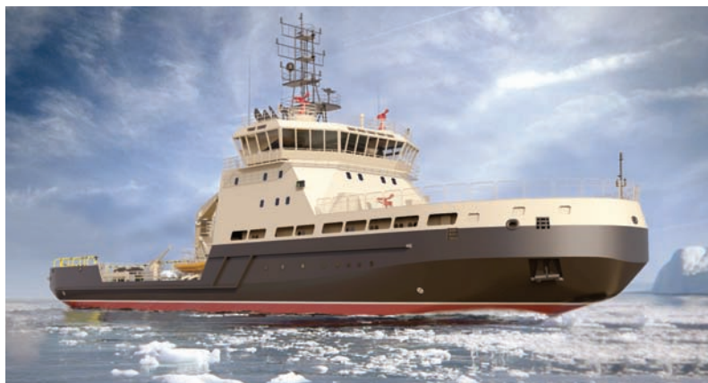
Многофункциональный ледокол пр. 21180М мощностью 7МВт
