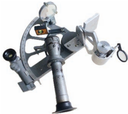
Рис. 1. Секстан с поворотным большим зеркалом
