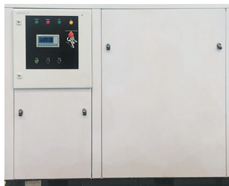
Рис. 4. Компрессор КСС45 (вид со стороны обслуживания)
