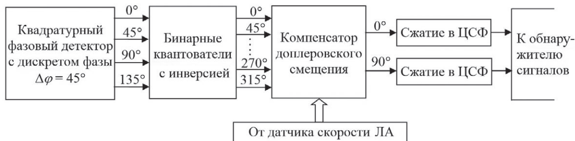
Рис. 2. Схема обработки принимаемого ФМ сигнала
