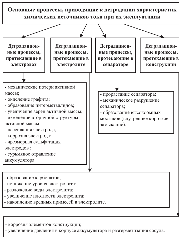
Рис. 4. Основные процессы, приводящие к деградации характеристик ХИТ при их эксплуатации
