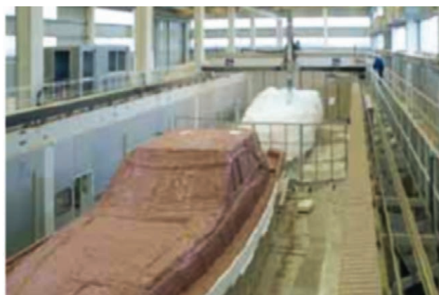
Рис. 5. Две матрицы на разных стадиях изготовления в рабочей зоне станка
