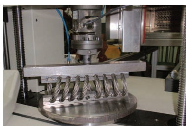
Рис. 2. Внешний вид ВЦК при проведении статических испытаний на универсальной испытательной машине при сжатии в направлении оси Z
