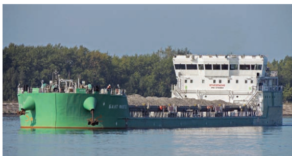
Рис. 4. Комбинированное судно-платформа/танкер пр. RST54. Перевозка насытного груза Автор фото Валерий Мазин
