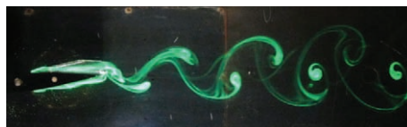
Рис. 6. Хорошо видно значительное уменьшение интенсивности вихрей нижнего ряда и их разрушение
