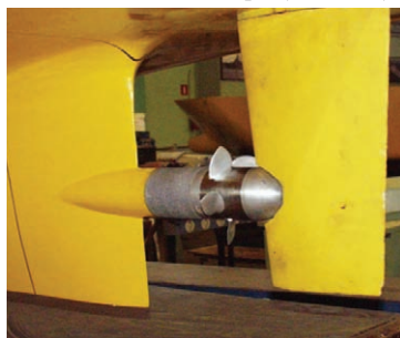
Рис. 6. Кормовая оконечность модели судна при моделировании малого хода под действием контрпропеллера
