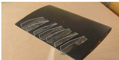
Рис. 2. Модель крыла с вихрегенераторами продольных вихрей.
