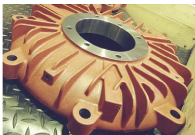
Крышка корпуса взрывозащищенного электродвигателя после механической обработки
