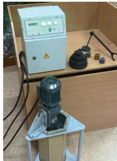
Рис. 2. Общий вид стенда для испытаний модельных образцов зубчатых колес
