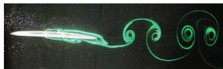
Рис. 9. Уменьшение амплитуды колебаний с \alpha=4^\circ до \alpha=3^\circ приводит к уменьшению ширины вихревого следа и зоны отрыва потока на нижней поверхности крыла (в сравнении с рис. 8). Фото 9,а и 9,б сделаны в различные моменты
