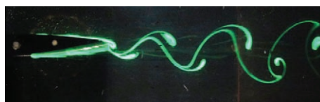
Рис. 4. Дорожка вихрей за колеблющимся крылом. Шаг между вихрями увеличивается при уменьшении частоты колебаний
