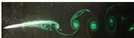
Рис. 7. Образование двух систем вихрей возле крыла. Фото 7,а и 7,б сделаны в различные моменты
