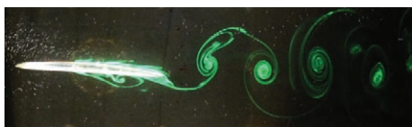
Рис. 7. Образование двух систем вихрей возле крыла. Фото 7,а и 7,б сделаны в различные моменты
