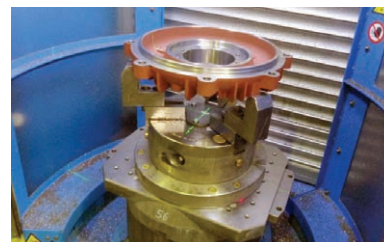
Деталь, установленная в приспособление на паллете, на станции загрузки/выгрузки
