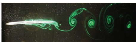
Рис. 8. Слияние двух вихревых систем. Фото 8,а и 8,б сделаны в различные моменты
