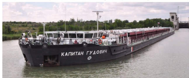
Рис. 12. Сухогрузное судно с пониженным надводным габаритом пр. RSD44
