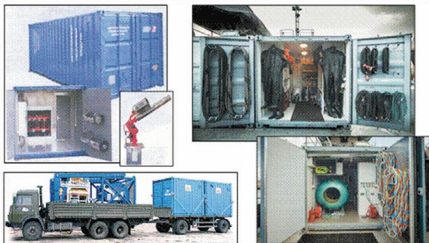
Рис. 7. Мобильные спасательные модули в контейнерном исполнении
