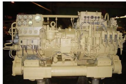
**Газоплотный компрессор для надводных кораблей и подводных лодок**
