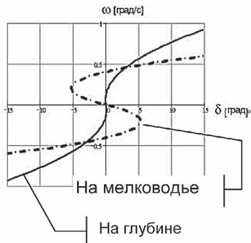
Рис. 3. Диаграммы управляемости модели движения судна
