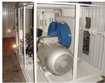
**БВКС – блочная воздушная компрессорная станция**
