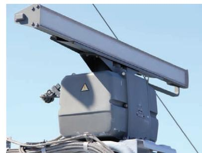
Рис. 1. Антенна НРЛС МР-231-2 «Лиман», разработчик – НПО «Горизонт»
