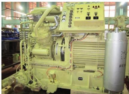
**Компрессорная станция высокого давления для надводных кораблей и подводных лодок**
