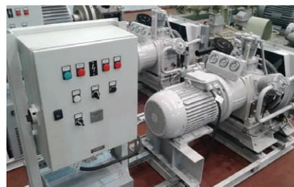
**Компрессор пускового воздуха для АЭС**
