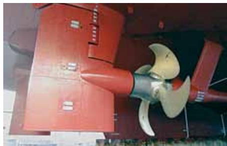
Рис. 12. Устройство «Rudder Bulb» [12]
