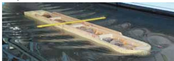
Рис. 8. Буксировка модели сухогруза-толкача пр. RSD67 на глубокой воде,  $Fr = 0,146$
