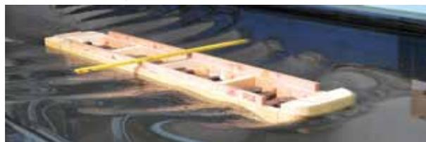
Рис. 10. Буксировка модели баржи пр. RDB67 на глубокой воде,  $Fr = 0,165$
