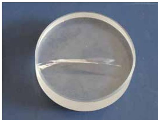
Рис. 2. Характер разрушения светопрозрачного элемента
