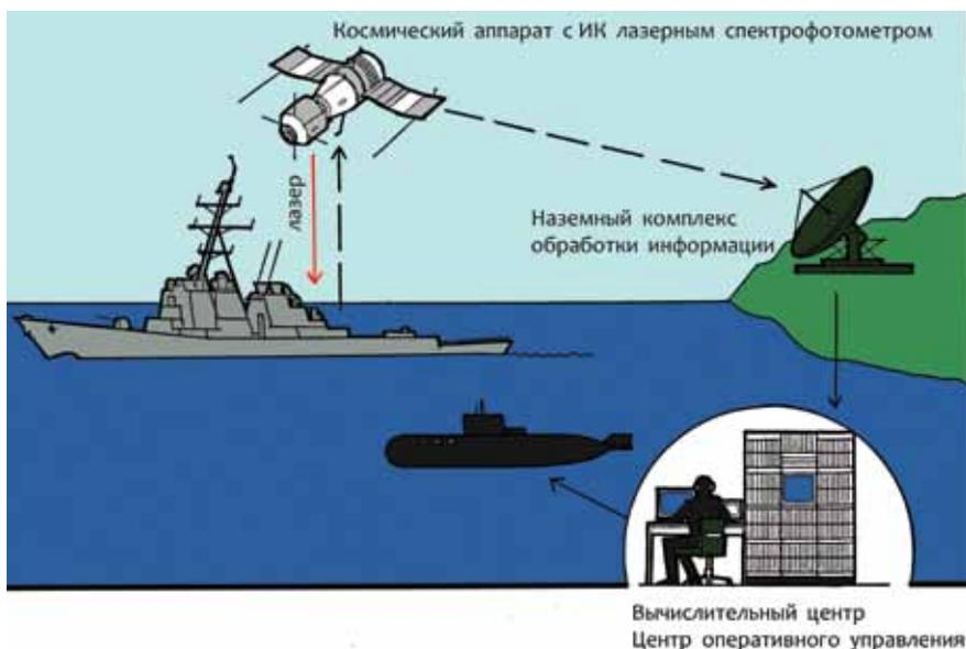
Рис. 5. Принципиальная схема определения корабля с помощью ИК-идентификации лакокрасочного покрытия
