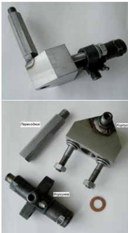
Рис. 2. Топливоздушный смеситель и его детали
