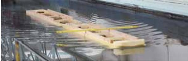
Рис. 13. Буксировка модели составного судна на глубокой воде,  $Fr = 0,099$
