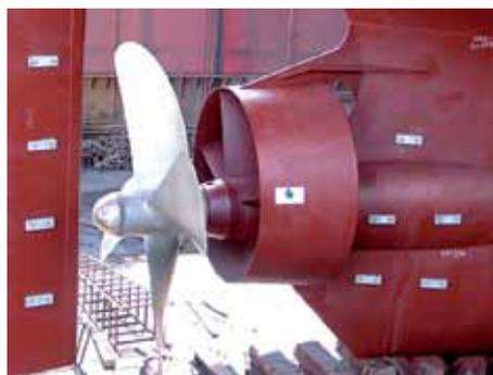
Рис. 11. Устройство повышения эффективности гребного винта «Mewis Duct» [11]
