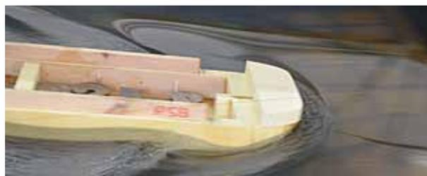
Рис. 11. Подпорная волна у носовой части модели баржи пр. RDB67 на глубокой воде,  $Fr = 0,165$
