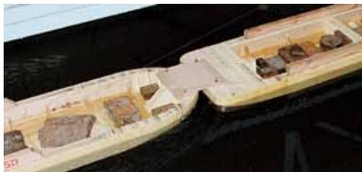
Рис. 5. Соединение корпусов моделей судна-толкача и баржи
