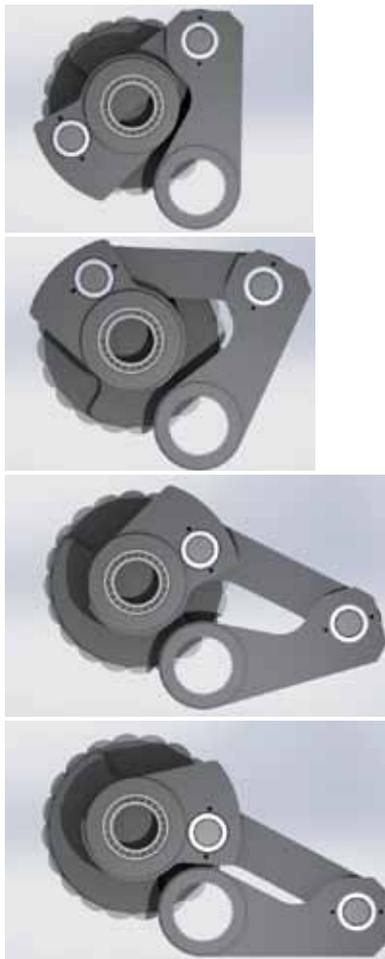
Рис. 7. Работа четырехзвенного механизма ЭПВМ-350 в нескольких фазах
