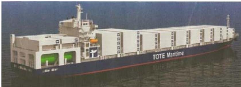
Рис. 4. Так будет выглядеть контейнеровоз транспортной группы TOTE с экологичной двигательной установкой и размещенными на палубе емкостями для сжиженного природного газа
