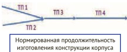
Здесь ТП 1 – изготовление полотнища; ТП 2 – изготовление сборного набора; ТП 3 – соединение ребер жесткости (РЖ) с полотнищем; ТП 4 – соединение балок сборного набора с полотнищем.
