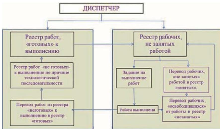
*Система организации управления работами по изготовлению корпуса судна на основе информации в информационном обеспечении*
