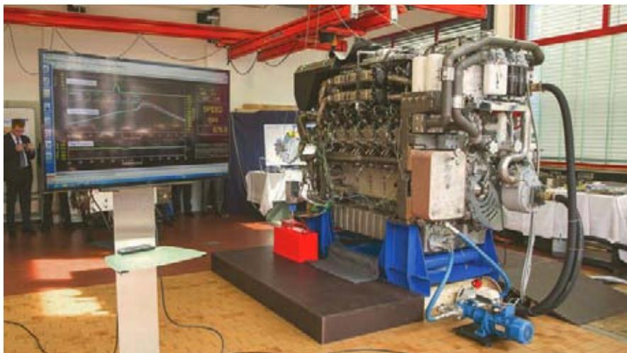
В них воплощены все передовые технические решения мировой инженерной мысли: топливная система с давлением впрыска до 2500 бар, двухступенчатый турбонаддув с промежуточным охлаждением, система рециркуляции отработавших газов и система автоматического управления, контроля и защиты.
