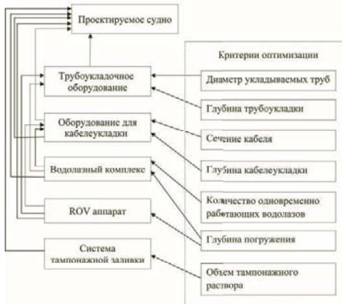
Рис. 1. Структурная схема влияния критериев оптимизации на технологическое оборудование
