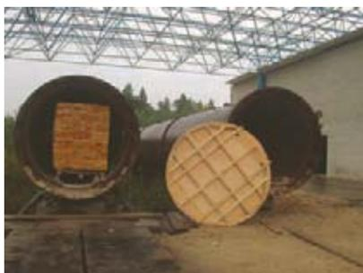
Рис. 5. Процесс акустического удаления влаги из пиломатериалов на лесопильном участке: а – под навесом; б – результаты испытаний; в – в емкости автоклава
