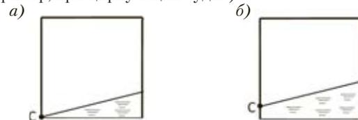
Рис. 4. Поперечное сечение секции рецесса и возможное положение поверхности воды в ней при наклонении
