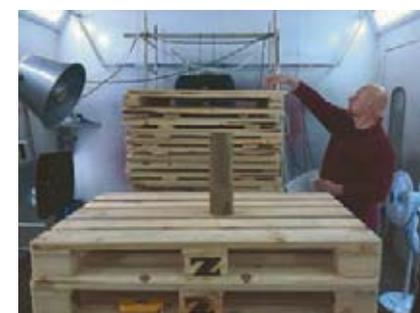
Рис. 6. Процесс акустического удаления влаги из пиломатериалов на деревообрабатывающем участке: а – внешний вид камеры; б – структурная схема камеры; в – вид камеры изнутри
