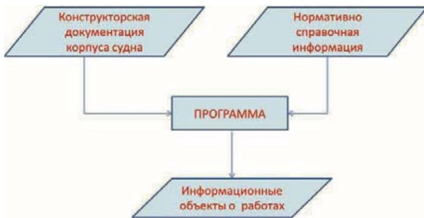
*Схема формирования информационных объектов, необходимых для управления работами при изготовлении корпуса судна*
