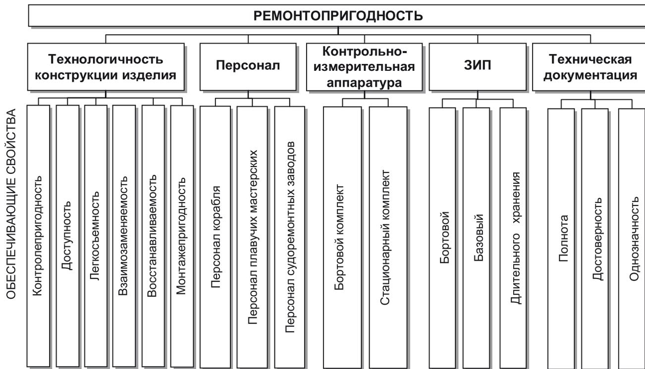
Рис.4. Составляющие свойств ремонтпригодности корабельного оборудования
