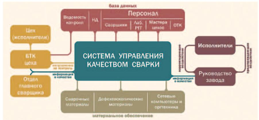
Схема системы управления качеством сварки
