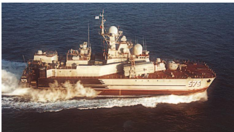
*Ракетный корабль на воздушной подушке скегового типа «Сивуч»*
