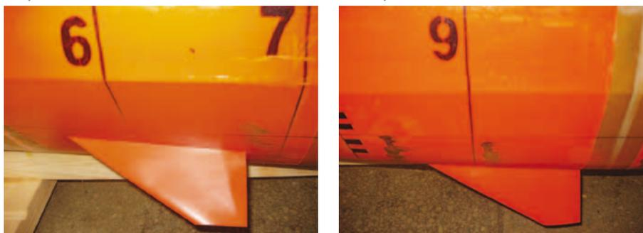
Рис. 3. Крылья, расположенные на модели в районе шп. 6 (а) и шп. 9 (б) (вид сбоку)
