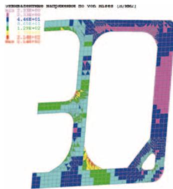
Рис. 10. Распределение эквивалентных напряжений по Мизису рамном шп. 87
