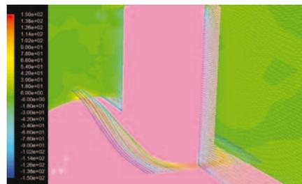
Рис. 10. Визуализация вихревой трубки подпорного вихря при помощи линий тока и поля спиральности (в плоскости, перпендикулярной диаметральной) и векторного поля скорости для модели DARPA SUBOFF
