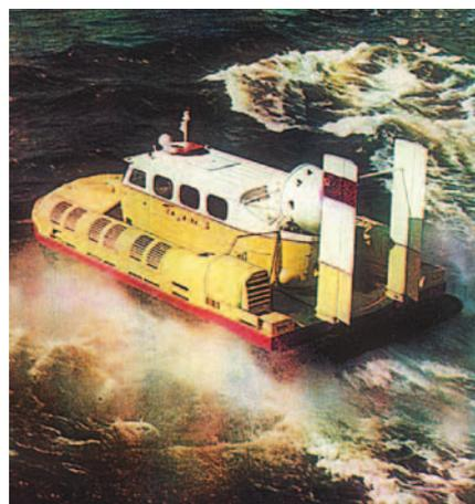
*Экспериментальный катер на воздушной подушке «Бриз»*
