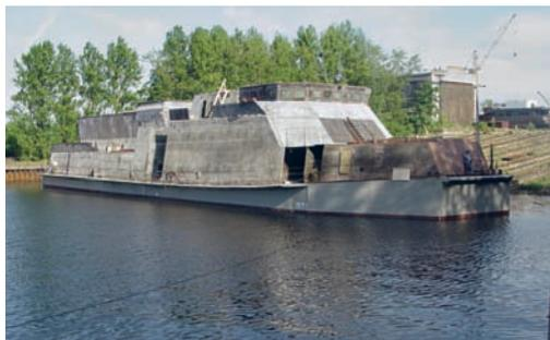
Рис. 1. Транспортировка надстройки
