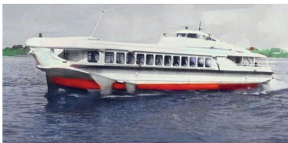
*Речной теплоход на подводных крыльях «Ракета»*
