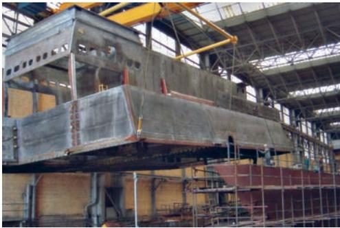
Рис. 6. **Погрузка блока надстройки**
