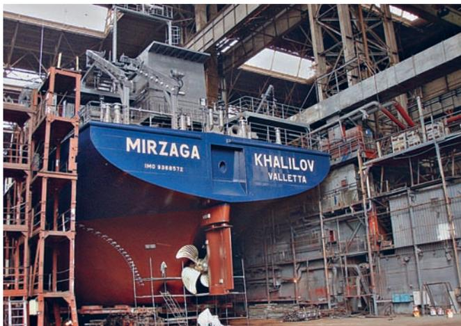
Рис. 6. Винторулевой комплекс судна проекта RSD17
