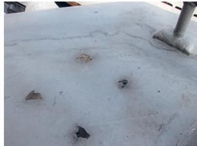
Рис. 19. Отверстия на открытой палубе после демонтажа насыщения
