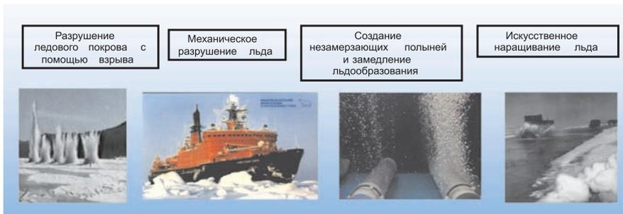
Рис. 5. Технологии искусственной модификации ледяного покрова
