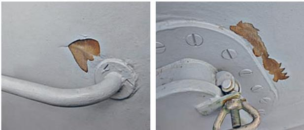
Рис. 12. Скол шпатлевки в районе наформовки под крепление поручня и обформовки выреза
