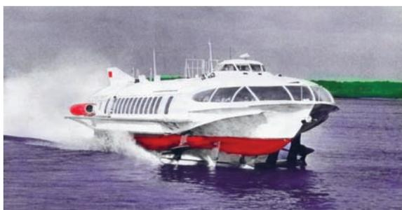
Речной газотурбоход на подводных крыльях «Буревестник»
