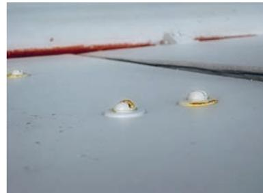
Рис. 17. Коррозия крепежа
