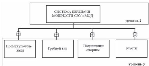
Рис. 3. Дерево событий для системы передачи мощности СЭУ с МОД
