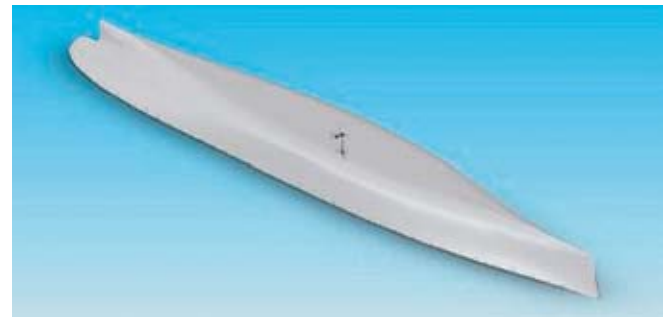
Рис. 7. Аксонометрия для проверки гладкости (по расчетным сечениям)
