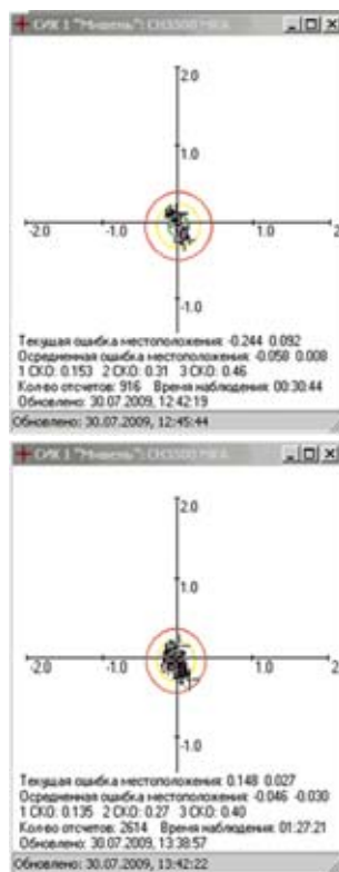
Рис. 7. Точность определения координат судна с учетом дифференциальных поправок
