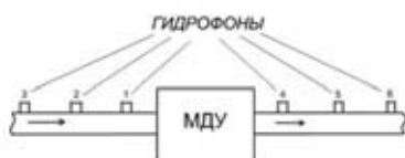
Рис. 2. Отрезок трубопровода Ду-50 с исследуемым изделием и гидрофонами
