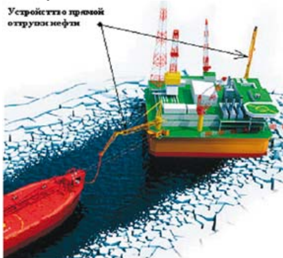
Рис. 1. Система прямой отгрузки нефти с МЛСП «Приразломная»
