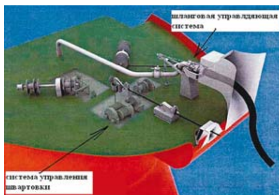
Рис. 6. Состав системы прямой отгрузки нефти на танкере
