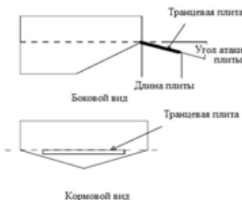
Рис. 3. Схема установки транцевой плиты в кормовой оконечности скоростного судна
