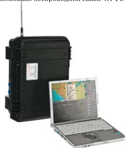
Рис. 5. Лоцманский транспондер «ТРАНЗАС АИС Т-603»
