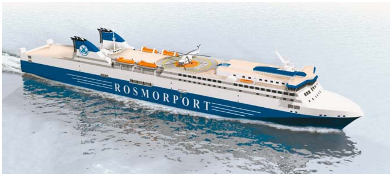
Железнодорожно-автомобильно-пассажирский паром для линии Усть-Луга–Балтийск–Засниц (Германия) пр. 00650
